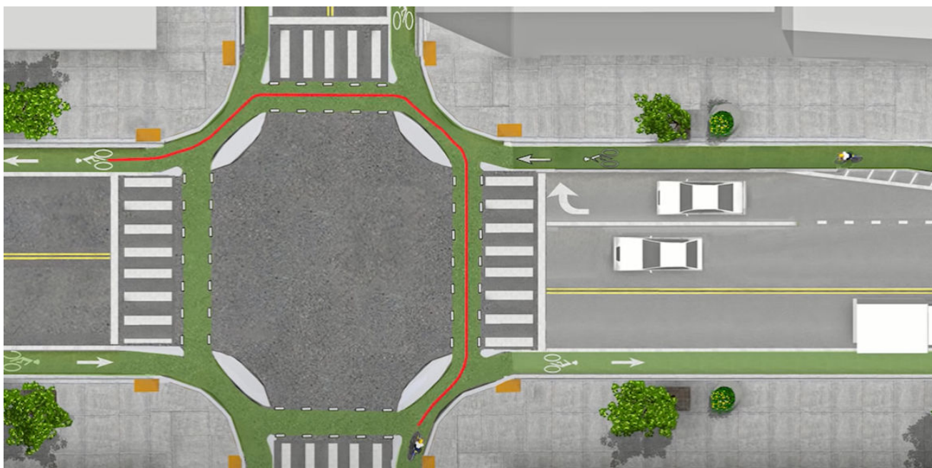
Obrázek 21 Příklad bezpečného vedení cyklistů křižovatkou svou sběrných komunikací. Holandsko. Jelikož bylo zjištěno, že vedení cyklistů v řazení zatížených křižovatek v hlavním dopravním prostoru je méně bezpečné.
